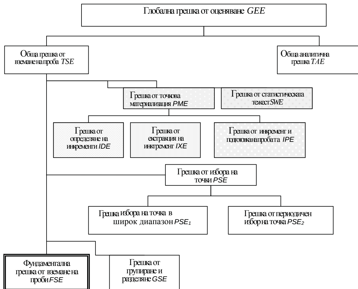
Фигура 3: Класификация на грешките от вземане на проби съгласно теорията за вземане на проби на Gy
